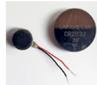
Vibracinis variklis micro 3VDC, 10 × 2,7 mm – 1 vnt. Ličio elementas CR2032 3V – 1 vnt.
