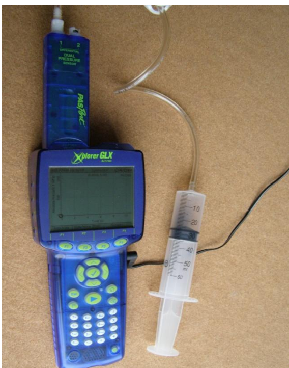
2 pav. Į pirmąjį GLX'o lizdą įjungtas slėgio jutiklis, kuris plastiko vamzdeliu su specialiu antgaliu sujungtas su švirkštu.
