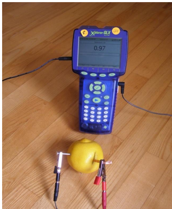
4 pav. Vario (Cu) ir cinko (Zn) elektrodai įsmeigti į citriną. Šis elektrocheminis elementas (galvaninis elementas) sukūrė 0,97 V elektrovarą. Duomenys šiuo atveju buvo atvaizduoti skaitmeniniame ekrane.
