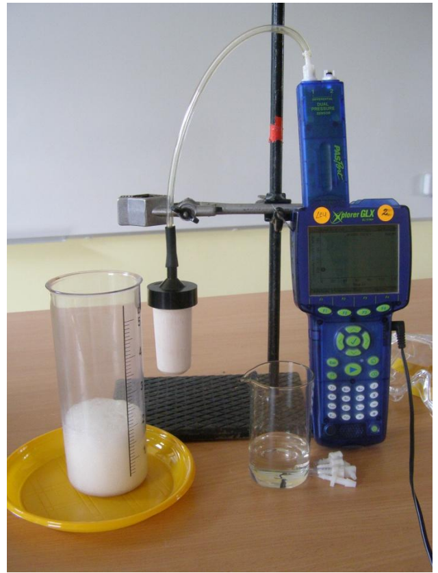
5 pav. b. Ant kreidos gabalėlių užpilis druskos rūgštis, vyksta reakcija, kurios metu gaminasi anglies dioksidas ( \text{CO}_2 ). Akytąjį indą į stiklinę įleiskite taip, kad jo dugnas nelieštų putų.
