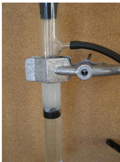
3 pav. Laboratorinis Kipo aparatas. Cinkas reaguoja su druskos rūgštimi.
