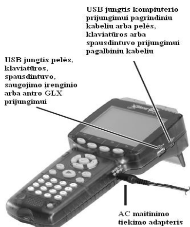
13 pav. Išorinių įrenginių prijungimas prie Xplorer GLX.
