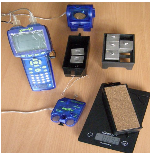
3 pav. Priemonės ir medžiagos trinties tyrimams su GLX'u ir dviem jutikliais atlikti.
