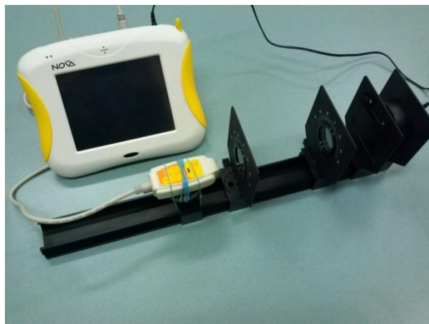
2 pav. Priemonių parengimo darbui schema. Ant optinio suolo (iš kairės į dešinę): apšvietumo jutiklis, analizatorius, poliarizatorius, ekranas su vienu plyšiu, šviesos šaltinis.
