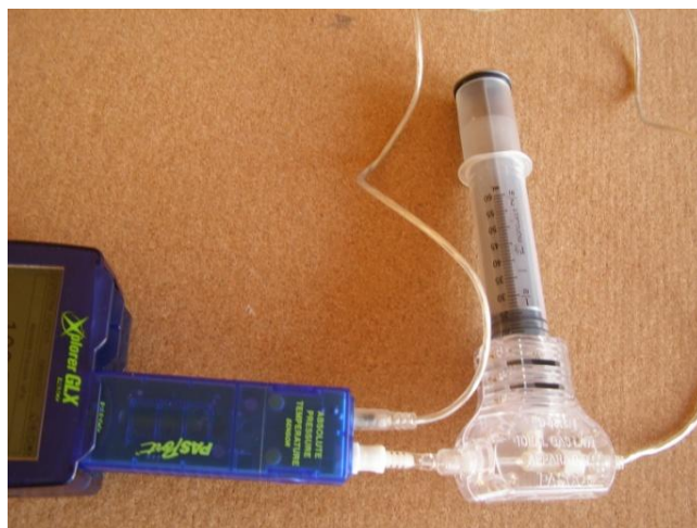
2 pav. Paveiksle matome mini erdvinę (stereo)jungtį įjungtą į Slėgio /Temperatūros jutiklio temperatūros lizdą (paveiksle toliau nuo mūsų) ir greito prijungimo/atjungimo jungtį - į jutiklio slėgio lizdą (paveiksle arčiau mūsų) Pats Slėgio /Temperatūros jutiklis prijungtas prie GLX'o.
