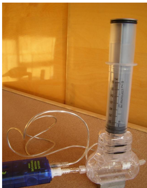
2 pav. a) Prietaisas idealiųjų dujų būvio lygties patikrinimui.
