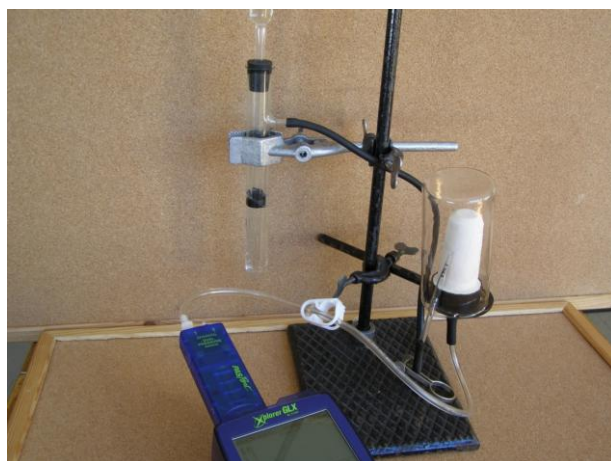
4 a pav. Akytasis indas apgaubtas chemine stikline ir skaidria žarnele sujungtas su slėgio jutikliu. Pastarasis įjungtas į pirmąjį GLX lizdą. Ant Kipo aparato atšakos užmauta juoda žarnelė. Antrasis jos galas pakištas po stikliniu gaubtu. Šia žarnele po gaubtu atkeliauja vandenilis.
