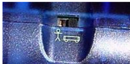
3 pav.a. Judėjimo/atstumo jutiklio perjungiklis perjungtas į padėtį vežimėlis (Cart).
