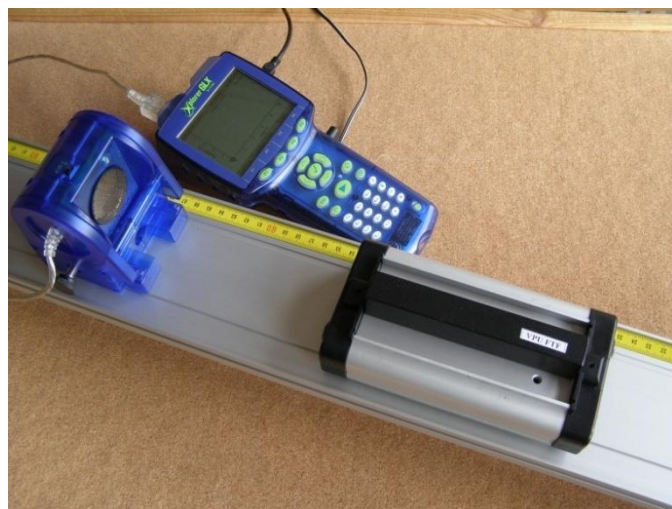
4 pav. Prieš atstumo jutiklį, apie 20 cm atstumu nuo jo, pastatytas vežimėlis. Judesio jutiklis įjungtas į pirmąjį viršutinį GLX'o lizdą
