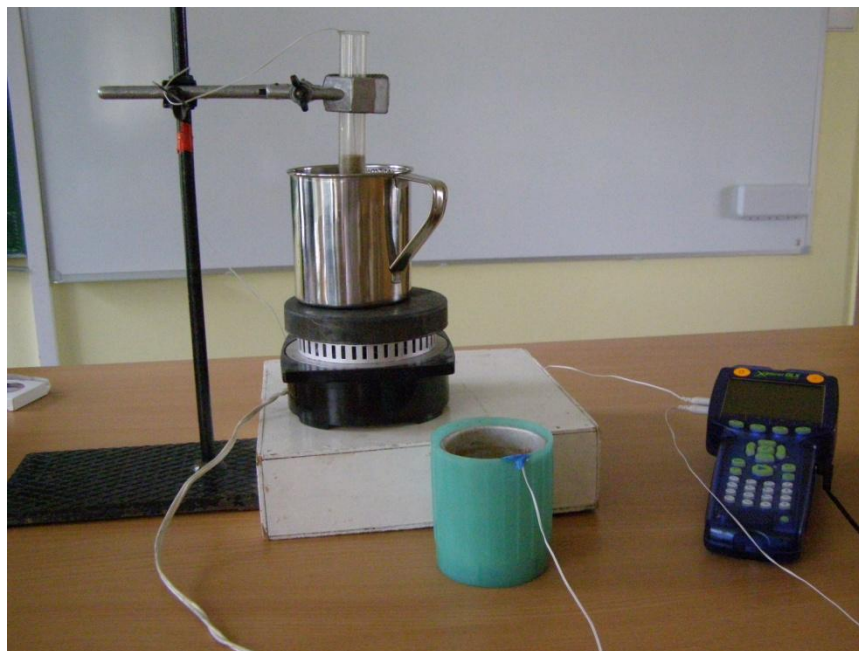
5 pav. Mėgintuvėlis su smėliu kaitinamas karštame vandenyje. Vienas temperatūros zondas mėgintuvėlyje su smėliu, antrasis- kalorimetre su kambario temperatūros vandeniu.
