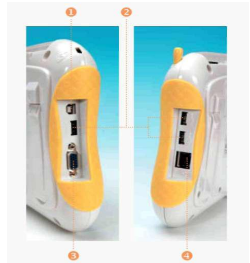
4 pav. Nova 5000 šonuose yra USB jungtys (1,2), CRT jūtis (3) bei interneto jungtis (4).
