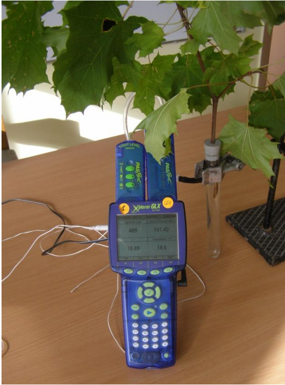
2 pav. Skaitmeniniame GLX ekrane galite tuo pat metu matyti slėgio, apšvietos ir temperatūrų vertes.
