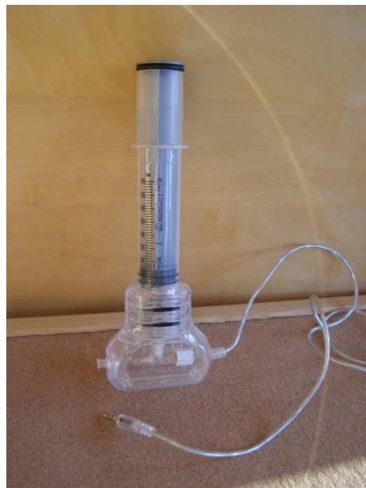
1 pav. Švirkštas, idealiųjų dujų būsenos dėsniui patikrinti. Įrenginys leidžia vienu metu atlikti suspaustų dujų temperatūros ir slėgio matavimus.
