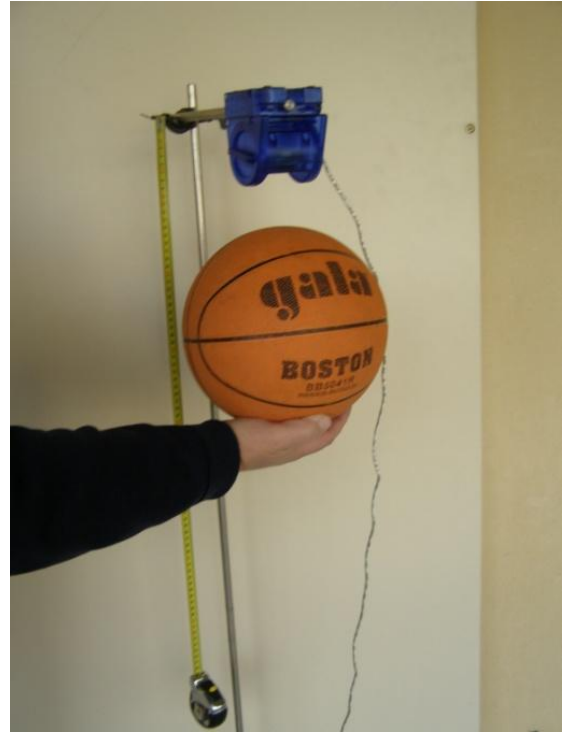
1 pav.a. Kamuolys laikomas 15-20 cm atstumu nuo judėjimo/atstumo jutiklio.
