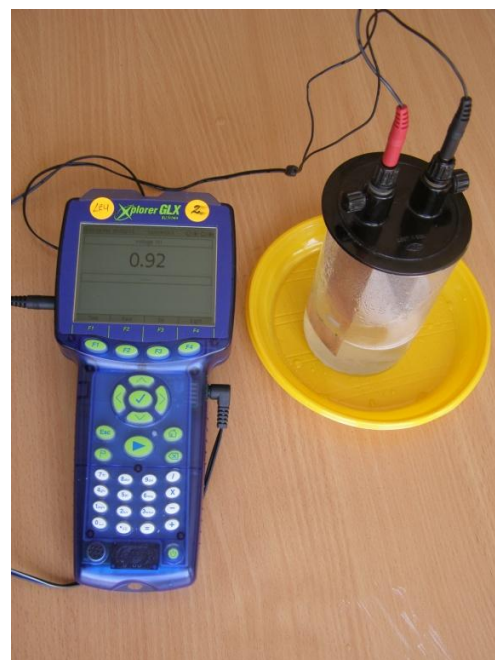
3 pav. Voltos tipo elektrocheminis elementas: vario (Cu) ir cinko (Zn) elektrodai įmontuoti plastiko dangtelyje ir įmerkti į druskos rūgšties (HCl) tirpalą. Elemento E matuojama įtampos jutikliu / zonu, prijungtu prie GLX. Įtampos jutiklio / zondo raudonasis gnybtas prijungtas prie vario elektrodo, juodasis – prie cinko elektrodo. GLX skaitmeniniame ekrane matome šio elemento sukurtą E = 0,92V
